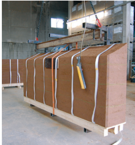
Der obere Wandabschluß ist 20° geneigt. Die weißen Bänder dienen zum späteren Heben und Versetzen.
