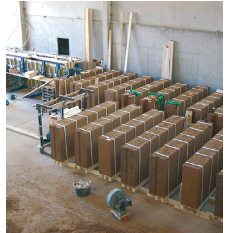
Insgesamt wurden 42 Elemente vorgefertigt und auf Holzpaletten bereit zum abtransportieren gelagert.
