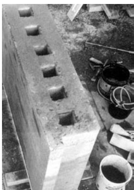
Vorfabrizierte Serien Lehmbauelemente mit integrierten Lüftungskanälen
