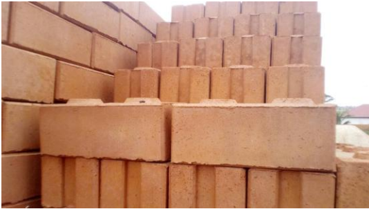
Die Lateritsteine von MAGGLO beruhen auf dem Interlocking-System
