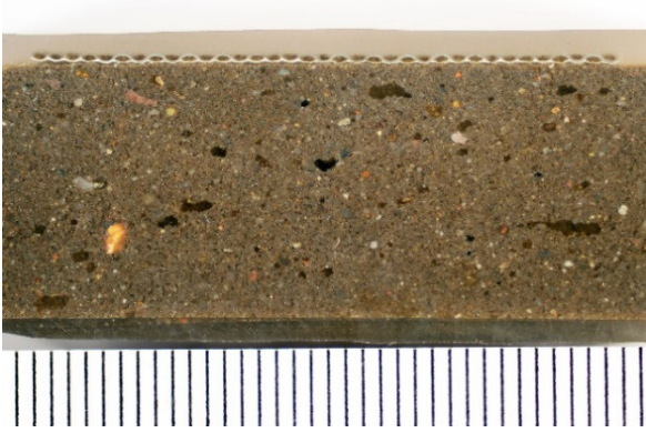
06 Anschliff einer Lehmputz-Verbundprobe (textiles Gewebe, flächig aufgeklebt mit Zellulosekleister)
