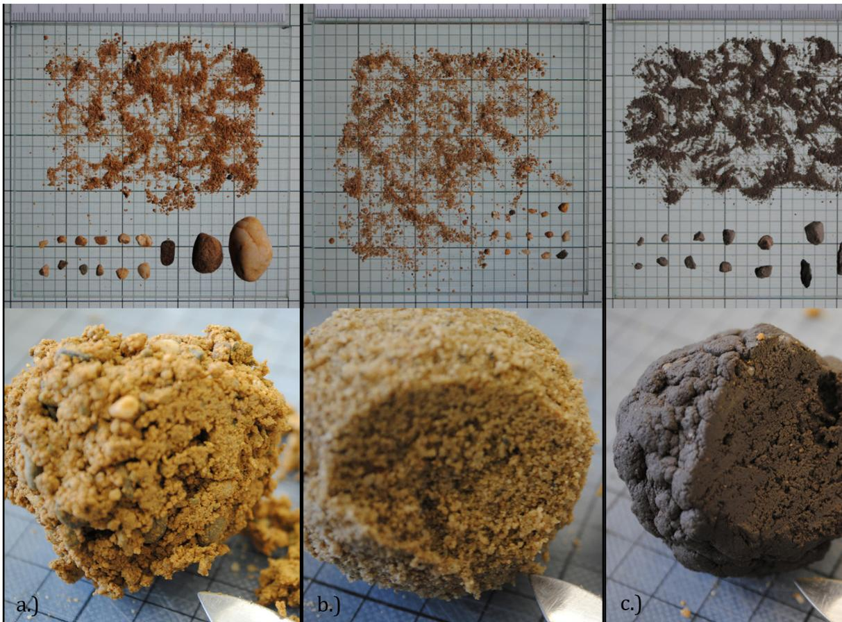
03 Die untersuchten tonhaltigen Mauerwerksabdichtungen. Links: Fertigmischung A. Mitte: Fertigmischung B. Rechts: Sächsischer Geschiebemergel. Aus Michette et al. (2017).
